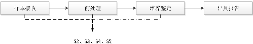
图2.5-6 微生物检测流程及产污环节图
