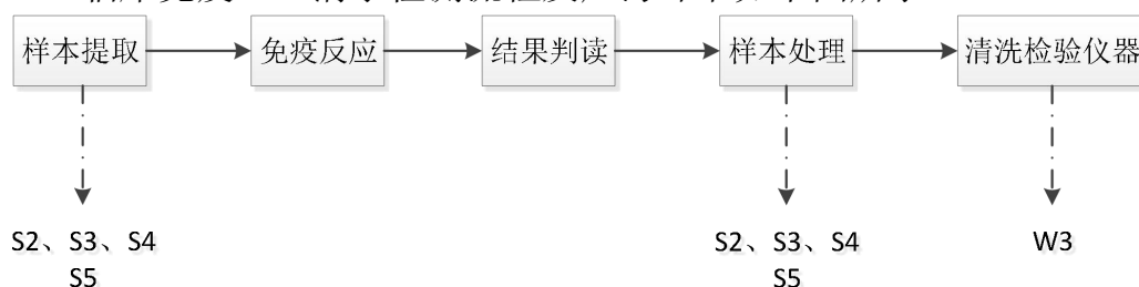
图 2.5-2 临床免疫、血清学检测流程及产污环节图
