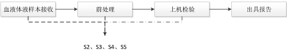
图2.5-5 检血液体液标本检测流程及产污环节图
