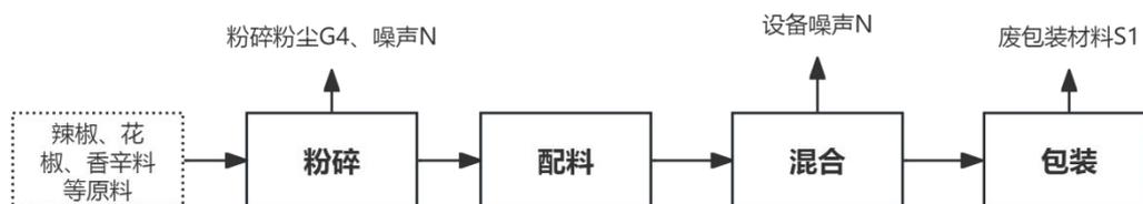
图 2-6 粉末调味料生产工艺流程及产污环节图
