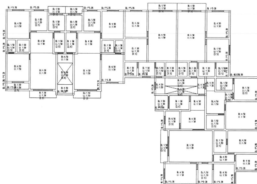
图 6.3-2 二至七层荷载简图
