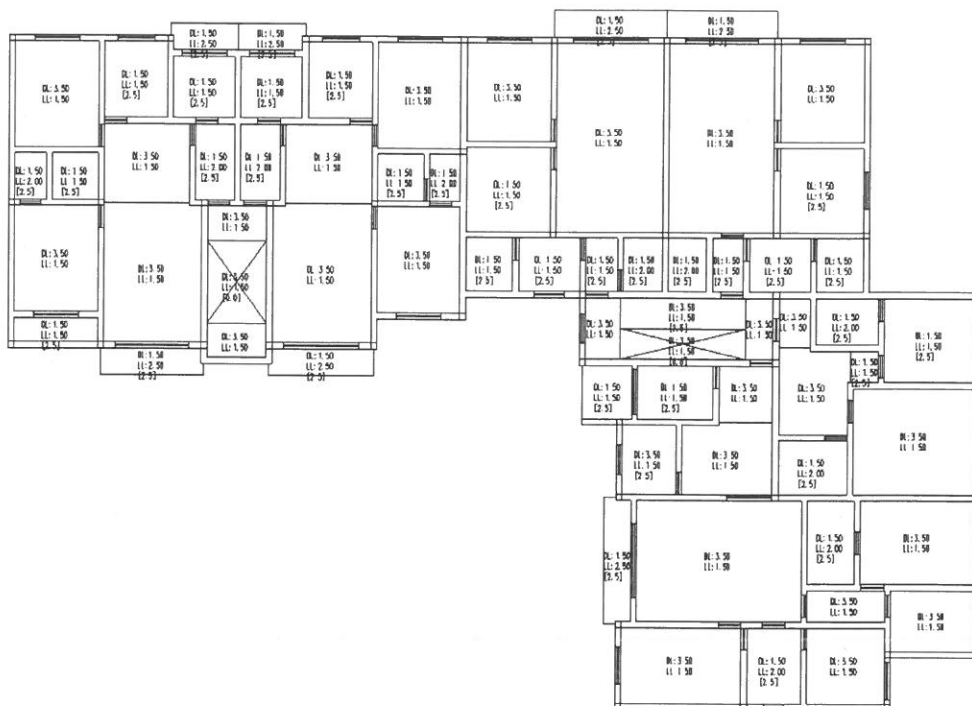
图 6.3-1 一层荷载简图
