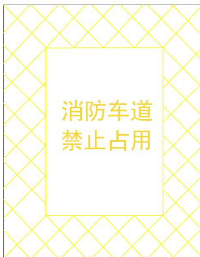
图 2：消防车通道出入口禁停标线及路面警示标志示例
